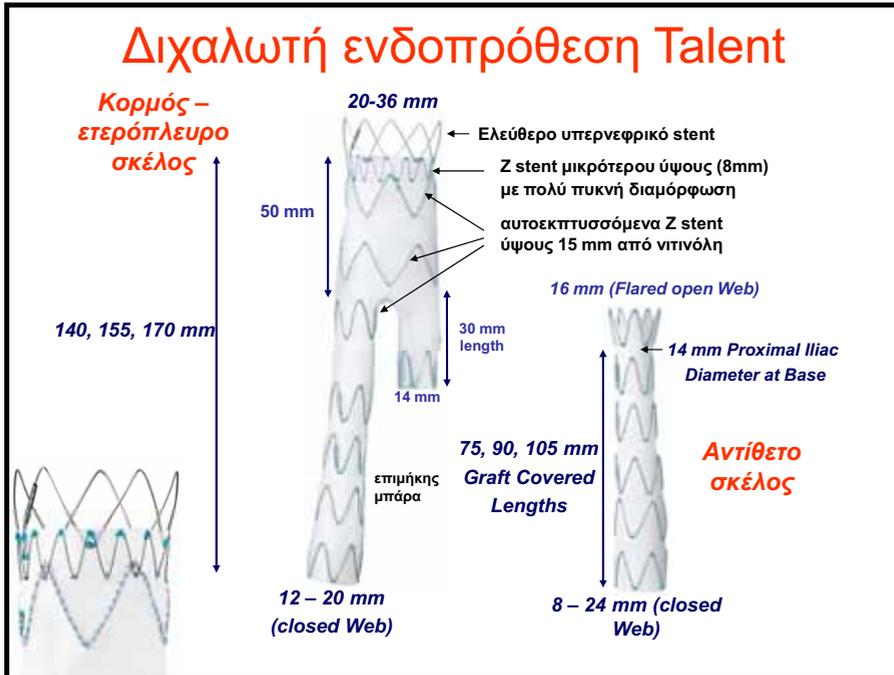
**Εικόνα 2.4.18:** Διχλωτή αρθρωτή ενδοπρόθεση Talent αποτελούμενη από κορμό – σύστοιχο σκέλος και ετερόπλευρο σκέλος. Αναφέρονται τα κατασκευαστικά χαρακτηριστικά και οι διαθέσιμες διαστάσεις (φωτογραφία τροποποιημένη από εγχειρίδιο εταιρείας Medtronic, Santa Rosa, CA, USA 2009).
