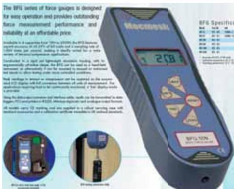
**Εικόνα 2.3.1 :** Δυναμόμετρο μεγάλης ακρίβειας BFG Mecmesin (φωτογραφία από εγχειρίδιο Mecmesin Limited, Newton House, Spring Copse Business Park, Sllfold, West Sussex RX13 OSZ, England, [www.mecmesin.com](http://www.mecmesin.com)).
